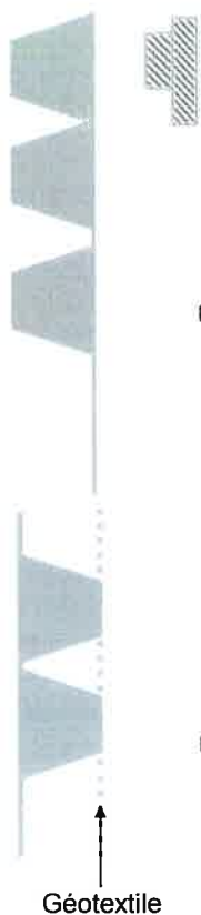
Figure 2 - Fixation haute de la nappe CALINAPPE ST (coupe verticale)
