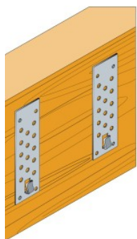
Fixation des platines sur la poutre porteuse
