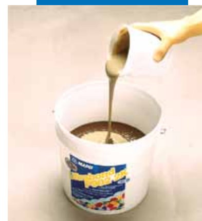
Versement du durcisseur dans la pâte (composant B)
