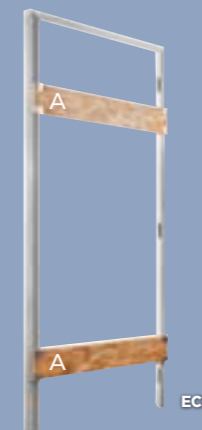
A : Les entretoises de passage protègent l'huissérie des déformations lors de la pose et sont retirées une fois la cloison entièrement réalisée.
