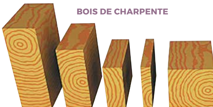
Panne 100 x 300 Madrier 75 x 225 Bastaing 63 x 160 et 63 x 175 Solivette 32 x 160 Poinçon 150 x 150
