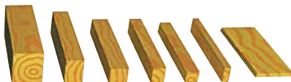
Chevron 63 x 75 1/2 chevron 38 x 63 Tasseau 38 x 38 Liteau 24 x 40 Liteau 27 x 27 Latte 20 x 38 Volige 105 x 14
