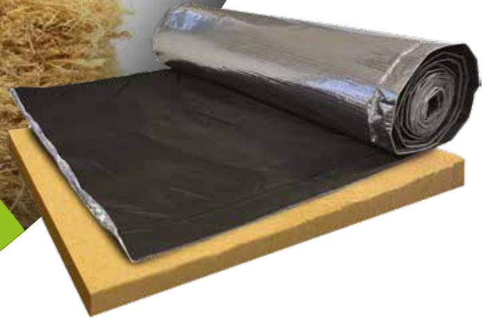
L'ATI MIX FIBRE DE BOIS 80 c'est la combinaison d'un isolant mince multi-réfecteur respirant, qui isole par thermo-reflexion, à un isolant épais à base de fibres de bois. Cette combinaison d'un rouleau souple et flexible qui s'adapte à toutes les formes de charpentes et d'un panneau biosourcé est une alliance innovante pour une isolation encore plus performante des toitures.
