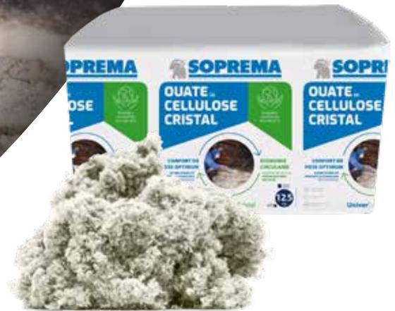
La ouate de cellulose UNIVERCELL CRISTAL est fabriquée à partir des papiers supports d'étiquettes autocollantes appelés "glassines". Cette matière innovante, biosourcée et performante, a pour avantage supplémentaire de dégager peu de poussière lors de sa mise en œuvre, par soufflage, à l'aide d'une cardeuse.
