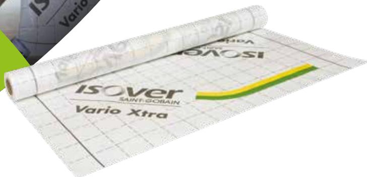
La membrane VARIO® XTRA, composée d'un film polymère quadrillé contrecollé sur un voile non tissé, est une membrane d'étanchéité à l'air hygro-régulante dont la résistance à la vapeur d'eau varie en fonction de l'humidité relative intérieure.
