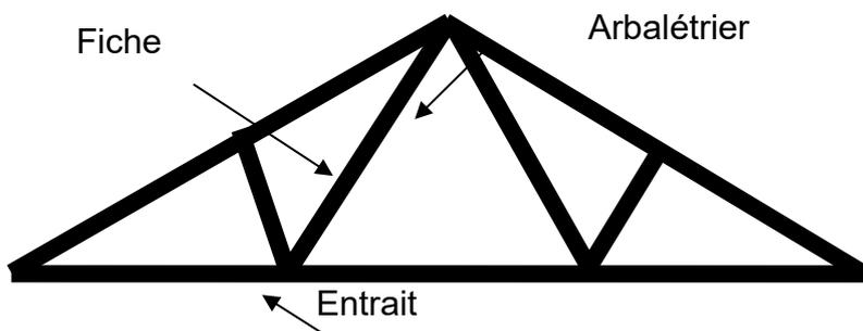
**Ferme** : élément triangulé constituant une charpente.
