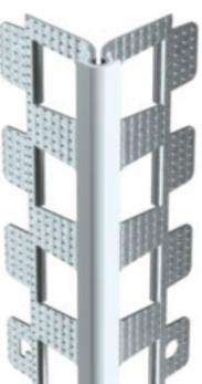
Profilé d'arête en acier galvanisé avec revêtement en PVC pour enduits intérieurs et extérieurs à partir de 10 mm. A usage vertical seulement. Longueur 2.5ml et 3ml.
